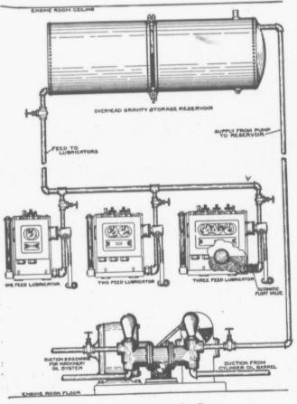
FIG. 2-DOUBLE-ACTING OIL PUMP
