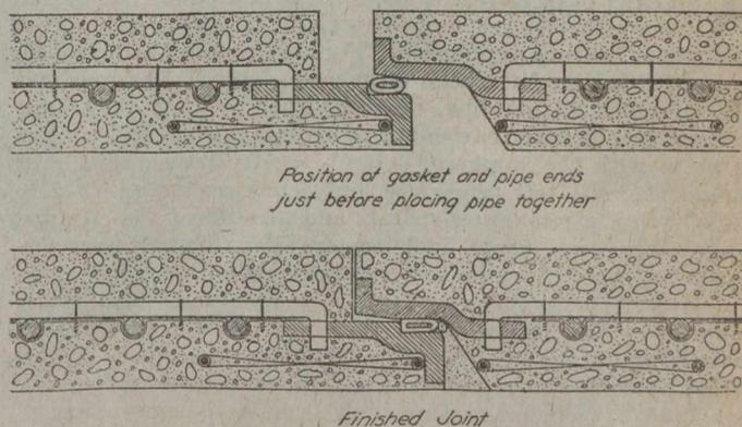
FIG. 2—NEW TYPE OF JOINT
