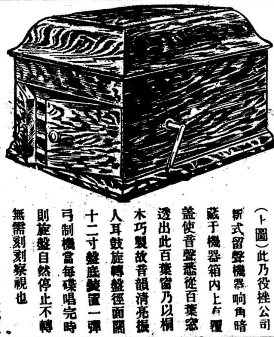
(卜圖)此乃役控公司新式留聲機器响角暗藏于機器箱內上有覆蓋使音聲從百葉窗透出此百葉窗乃以桐木巧製故音韻清亮振人耳鼓旋轉盤徑面闊十二寸盤底裝置一彈弓制機當每碟唱完時則旋盤自然停止不轉無需時刻察視也
