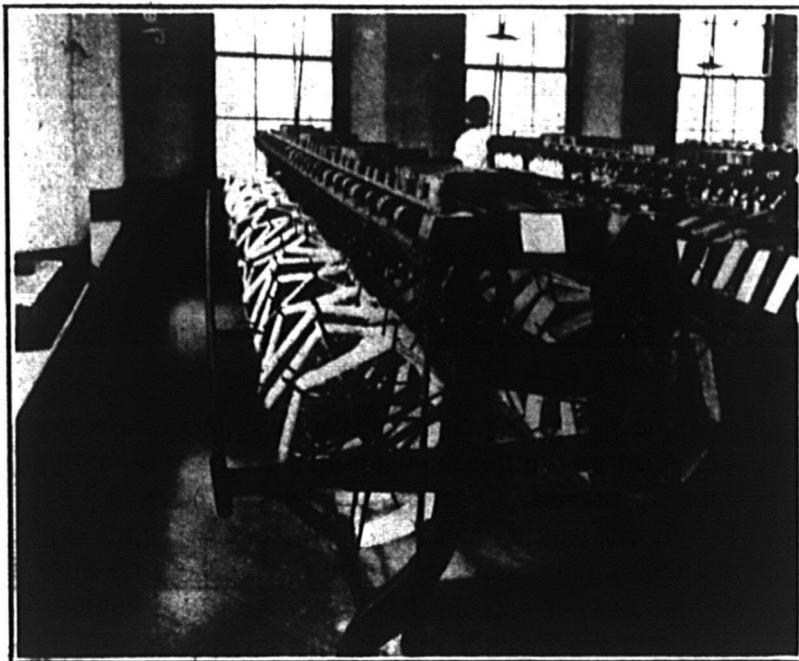
La vignette No 2, montre les machines sur lesquelles les fils passent de ces longs écheveaux aux bobines. Ces fils, qui mesurent 300,000 verges de long ou environ 170 milles par livre, sont tellement fins qu'ils ne sont pas visibles sur l'illustration.
