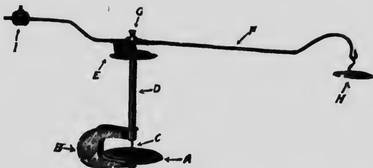
Régulateurs, lettres explicative.—A—Capsule contenant le mercure.—B—Console.—C—Tige qui fait fonctionner le levier.—D—Tuyau.—E—Support.—F—Lever.—G—Vis pour ajuster les régulateurs.—H—Couvercle qui ferme l'orifice du réchaud.—I—Contrepoids.
