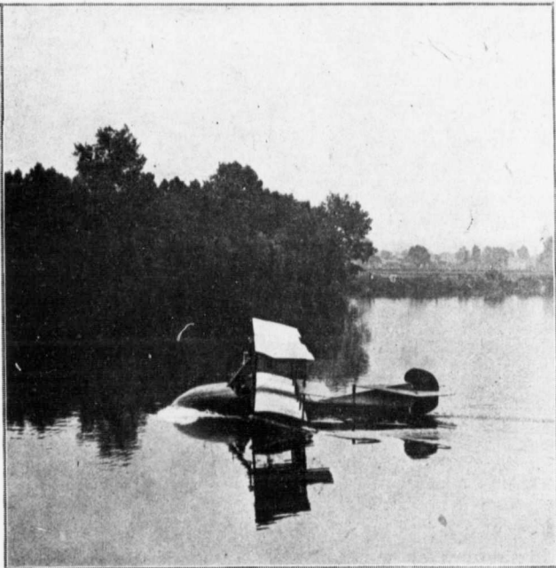
L'hydravion à stabilisateur gyroscopique, vu sur l'eau et dans l'espace
