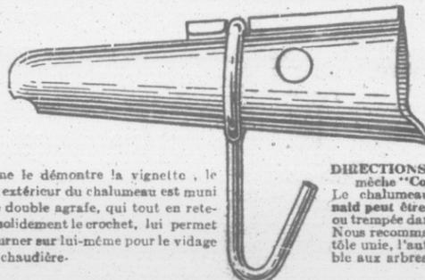
Comme le démontre la vignette, le point extérieur du chalumeau est muni d'une double agrafe, qui tout en retenant solidement le crochet, lui permet de tourner sur lui-même pour le vidage de la chaudière.
