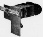
Fig. 14.-Wehnelt's Penetrometer.
