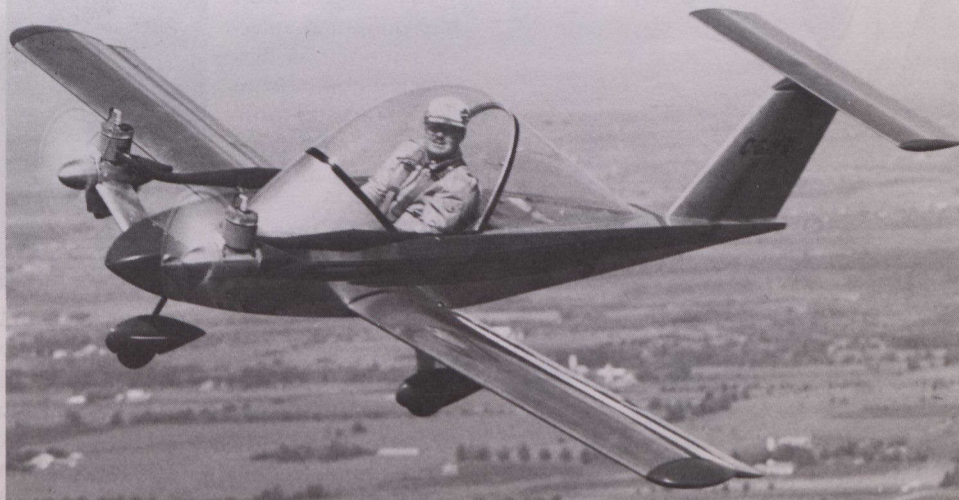
El nuevo Cricket MC-12 de la Zenair que su fabricante mantiene ser el bimotor más pequeño del mundo. Propulsado por dos motores de 15 caballos, alcanza una velocidad de crucero de 185 km por hora.
