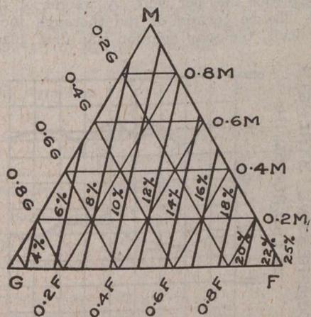
FIG. 2—PERCENTAGE OF WATER REQUIRED TO GAUGE GROUND QUARTZ SAND OF ALL GRANULOMETRIC COMPOSITIONS—FERET'S TRIANGLE
