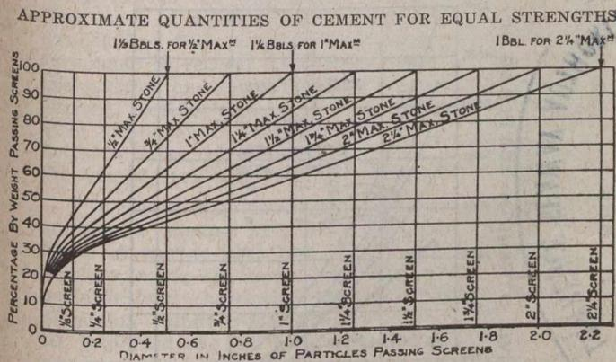
FIG. 1—FULLER'S CURVES FOR MAXIMUM DENSITY
