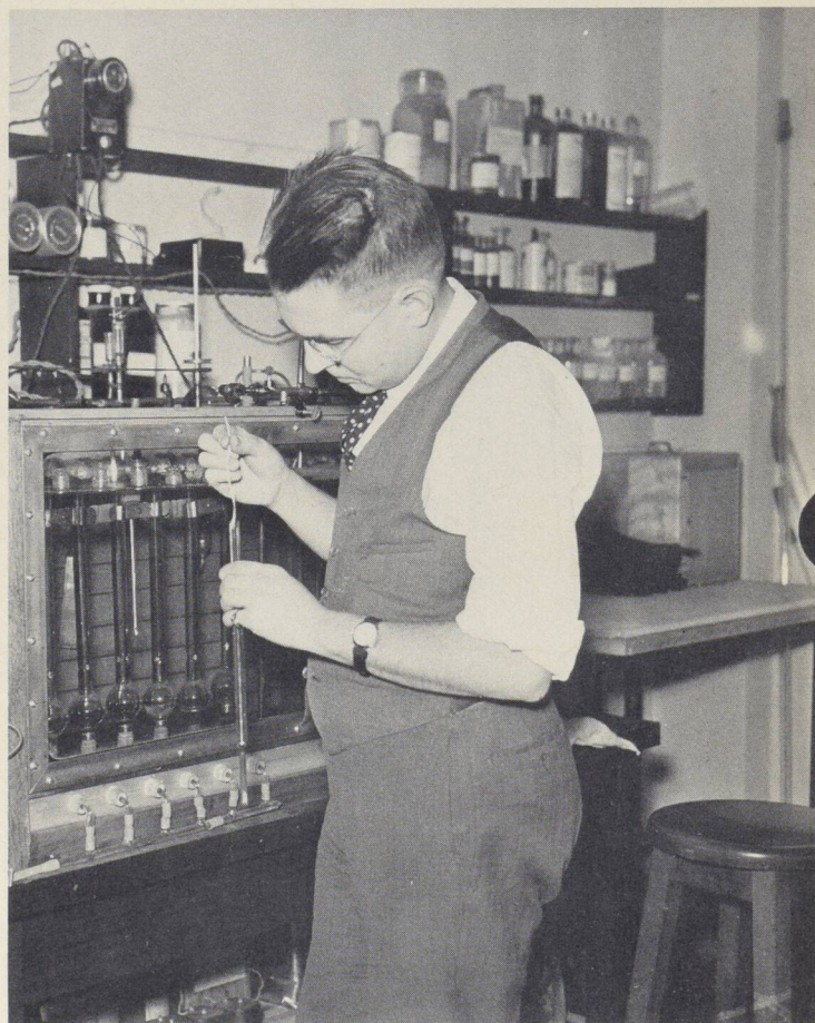
Mr. Bayley preparing to run a cuprammonium fluidity test — in the 1930s. A fluidity test is used to determine whether cellulose has been chemically damaged. • M. Bayley s'apprêtant à procéder à un essai de fluidité au cuivre ammoniacal, au cours des années trente. Cet essai permet de déterminer si la cellulose a été endommagée par action chimique.
