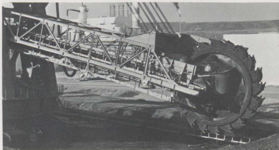
Une excavatrice à godets (diamètre de la roue : dix mètres) pour le prélèvement des sables bitumineux. Ceux-ci sont transportés à l'usine sur des convoyeurs.
