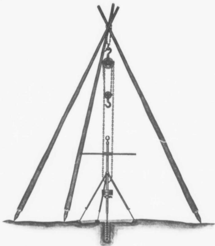
Fig. 4. Disposition d'une tarière pour forage de sable bitumineux.
