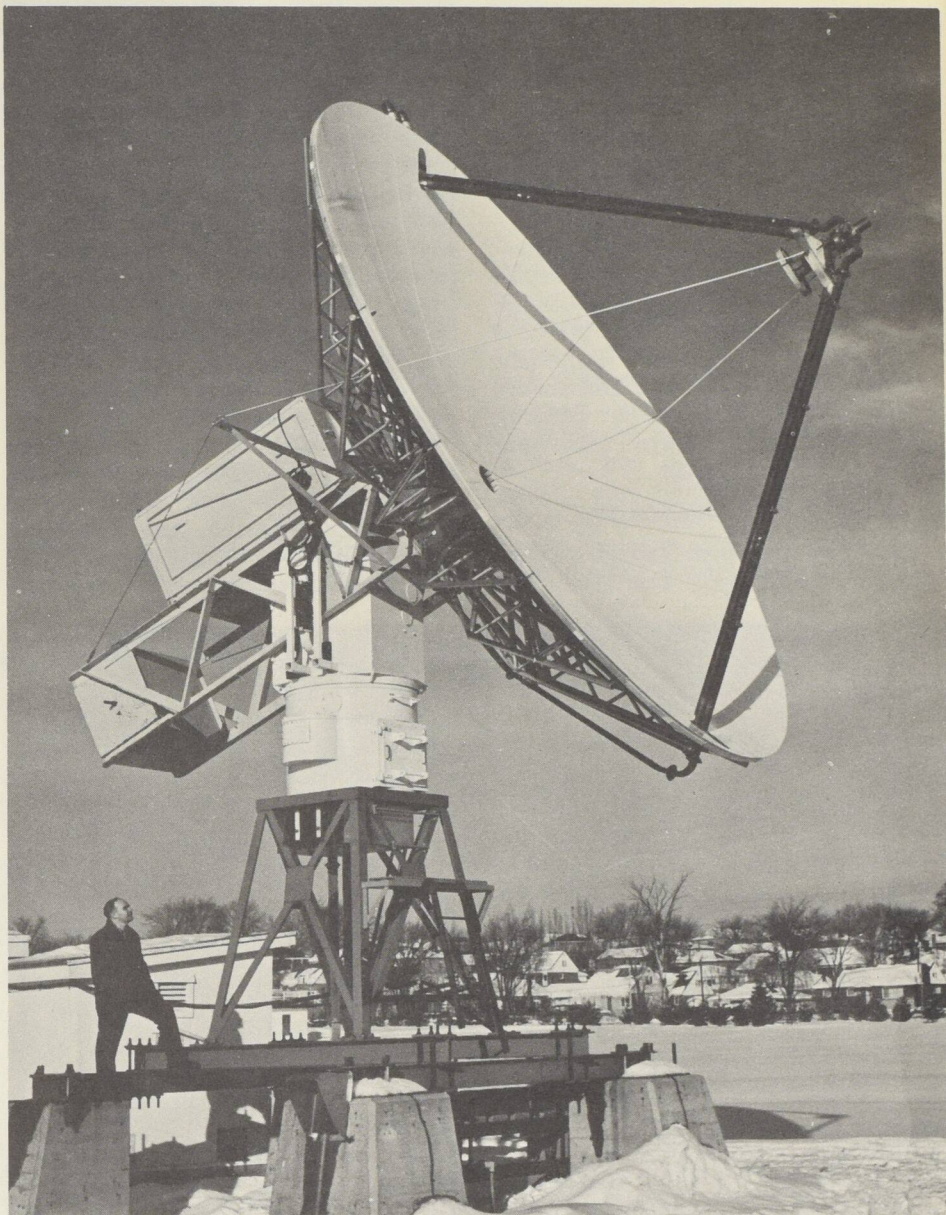
Radar-détecteur de grêle, mis au point au Conseil à Ottawa. Le radar mesure 22 pieds de diamètre.
