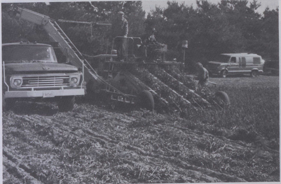
La récolteuse canadienne permet de récolter les cacahouettes quand elles sont encore humides, sans les endommager.
