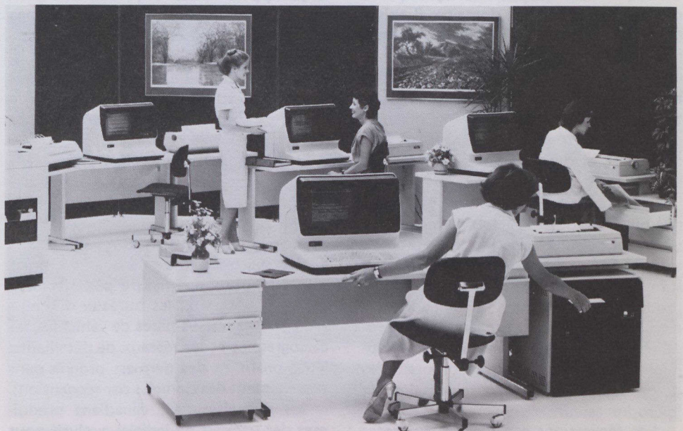
Version du AES C20 consistant en quatre postes de travail locaux (chacun muni d'un écran et d'un clavier électronique), cinq imprimantes atteignant chacune la vitesse de 540 mots/minute, une imprimante ligne par ligne dont la vitesse approche 8 000 mots/minute et une unité centrale (ou module central) renfermant le microprocesseur.
