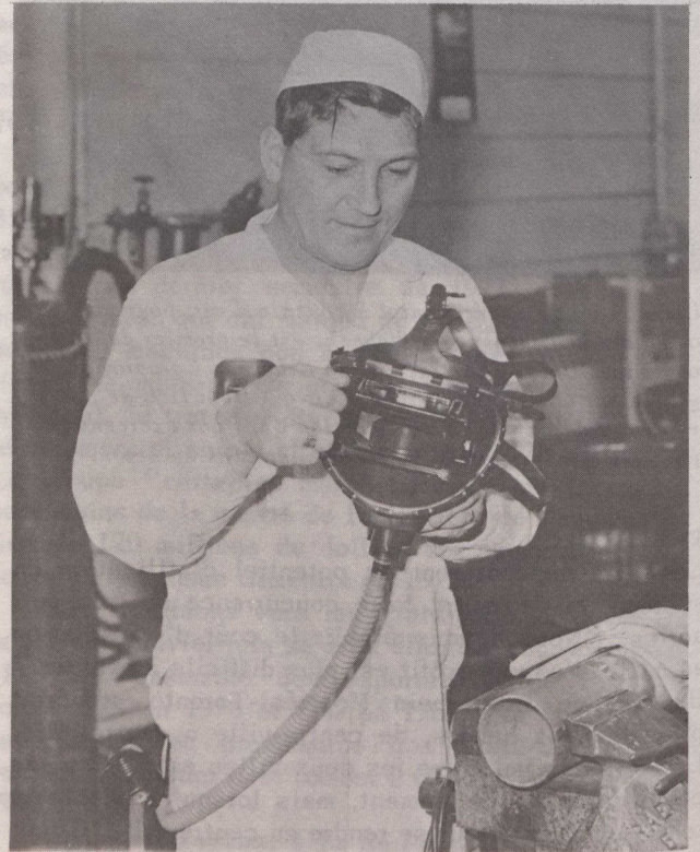
M. Bill Dereski, soudeur, est sur le point de mettre un casque à la fois compact et très pratique mis au point au Centre de recherches nucléaires de Whiteshell. Ce masque comporte une légère modification qui permet d'utiliser un système d'approvisionnement d'air complémentaire.
