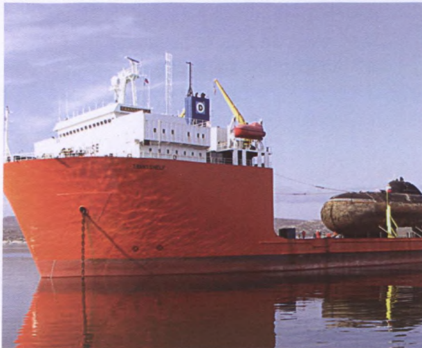
Un sous-marin à propulsion nucléaire déclassé est soulevé par un navire gros-porteur semi-submersible et amené au chantier naval pour être débarrassé de son combustible nucléaire et démantelé.
