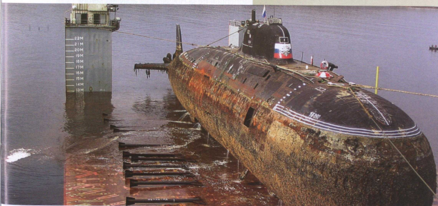
Le démantèlement d'un sous-marin nucléaire comprend jusqu'à 13 étapes, du transport jusqu'à l'enlèvement du combustible et au stockage du combustible nucléaire irradié.
