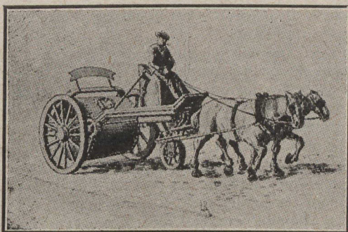
Le tonneau malaxeur de mortier ambulateur de M. Bodlaender
