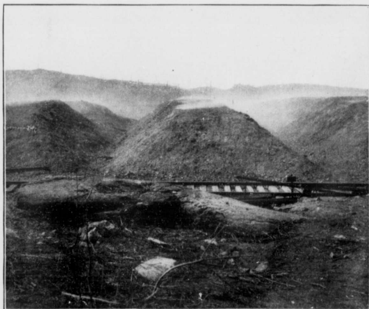
Lits de grillage, à Copper Cliff.
