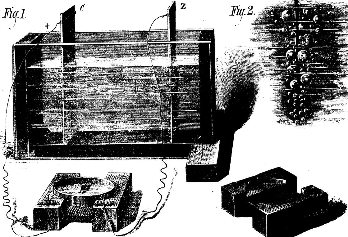
EXPERIMENTAL BATTERY AND GALVANOMETER.
