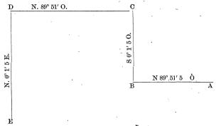
"Ces directions signifient que l'arpenteur a d'abord tiré les lignes de A à B, et de C à D, puis il est revenu à C et a pris une direction sud jusqu'à B, puis à l'ouest jusqu'à E et au nord jusqu'à D.
