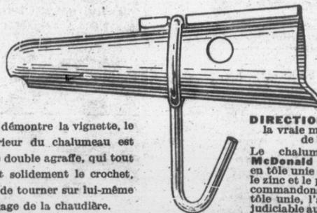
Comme le démontre la vignette, le Joint extérieur du chalumeau est muni d'une double agraffe, qui tout en retenant solidement le crochet, lui permet de tourner sur lui-même pour le vidage de la chaudière.
