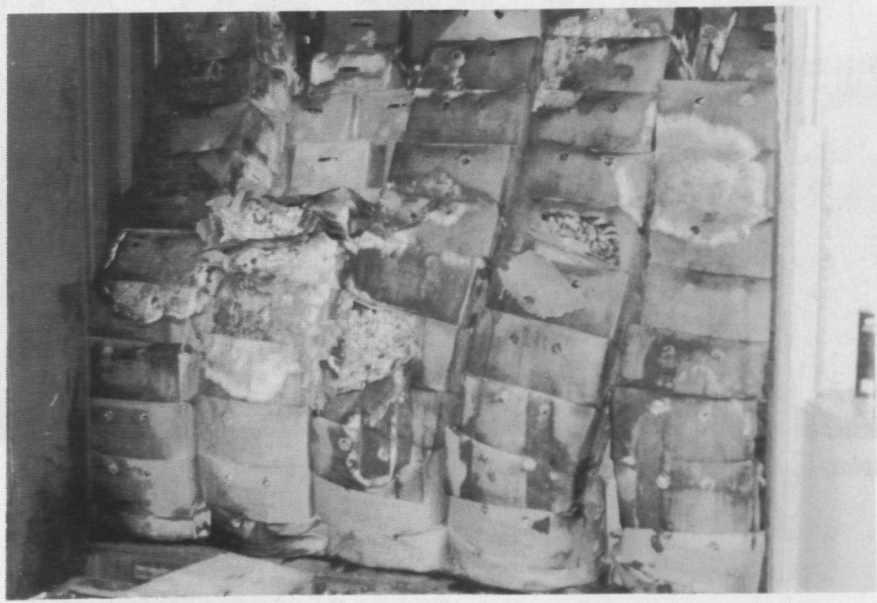
Chargement trop serré, pas de cloisons entre les groupes, conteneur qui fuit et dommages par l'eau.
