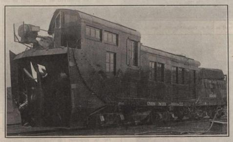
Fig. 27. Jull Centrifugal Snow Excavator.
