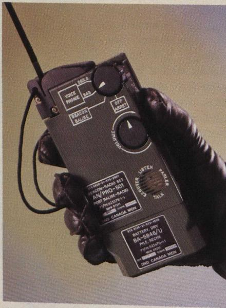
*Cette radiobalise de détresse portable, fabriquée par Garrett Manufacturing, émet un signal de radioralliment et permet des communications bilatérales en phonie avec l'aéronef de recherche.*
