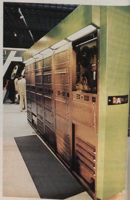
Autocommutateur numérique local DMS-100 de Northern Telecom. D'une capacité de 100 000 lignes, il peut s'intégrer aux réseaux de téléphonie privée, aux terminaux téléphoniques et téléinformatiques, au réseau militaire Autovon, au système de positions de maintenance et d'administration (MAP) et au système de positions automatisées de téléphonistes (TOPS).
