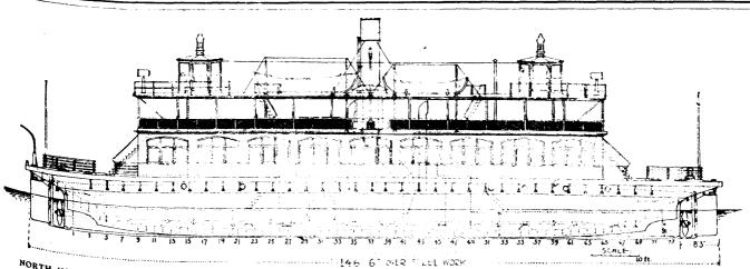
NORTH VANCOUVER FERRY AND POWER CO.'S COMPOSITE SCREW FERRY BOAT. COMBINATION INBOARD AND OUTBOARD PROFILE.
