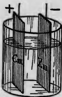
FIG. 81 SIMPLE VOLTAIC CELL
