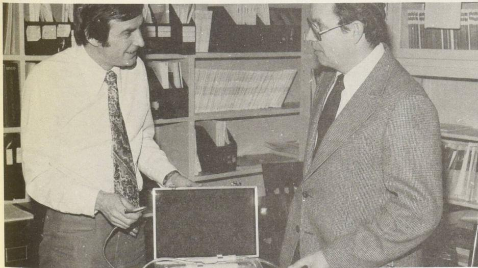
John Phillips essaie un modèle commercial de l'indicateur de rendement pour calorifère fabriqué par la compagnie VIDBEC, à Montréal. Cet instrument à pile fournit en quelques minutes une mesure précise de la température, de la concentration en gaz carbonique et de l'écoulement de l'air dans la cheminée. (Ph. Bruce Kane, CNRC)
