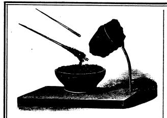
FIG. IO .- MAGNETIZATION BY LOADSTONE.
