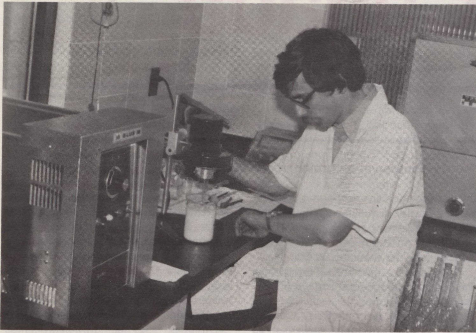
On a mis au point un lait écrémé enrichi (stérilisé par la méthode utilisant les très hautes températures) auquel on a ajouté des protéines du lait et des vitamines. M. Lester Dobosz mesure la viscosité du produit fini.
