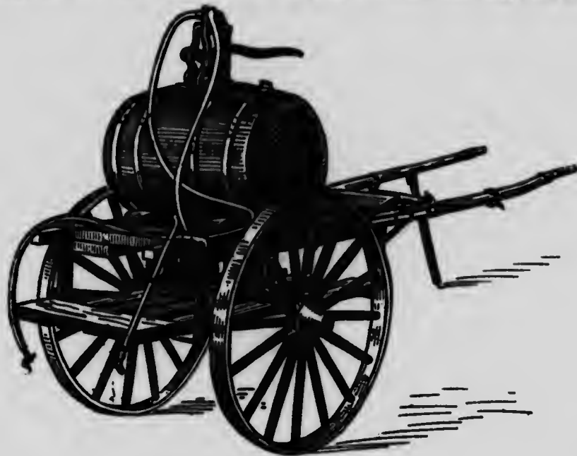
POMPE PULVÉRISATEUR SUR CHARRETTE.
