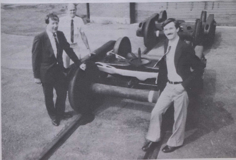
MM. Bill McLaren (à gauche) et Doug Dibble (à droite), du Centre de développement des transports de Transports Canada, présentent en compagnie de M. Frank Scott, ingénieur du CN (au second plan), un bogie orientable (autoguidé). Cet ensemble fait actuellement l'objet d'essais au Centre de recherches de CN Rail à Saint-Laurent (Québec).
