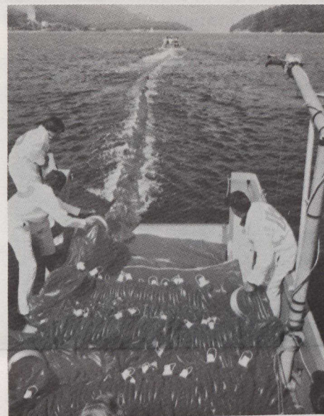
Le ZOOM est emballé dans des gaines compactes libérant des milles de barrage qui encerclent et retiennent la nappe de pétrole. Les écumeuses à disques récupèrent le pétrole avant qu'il ne cause de dommages.
