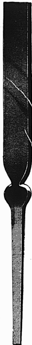
Figure montrant comment le Clou est forgé à chaud sur la tige à Clous.
