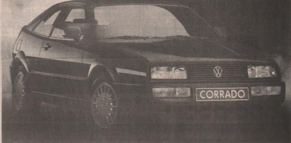
Corrado利用加長的前後輪距來擴大車廂的容積。由腳掣至後座背的長度剛好六呎，令Corrado足以成為一部四座位汽車。頭部空間比Sirocco高一吋半，但Corrado車尾短，行李廂比Sirocco小一點，後座背可左右分別摺下。
