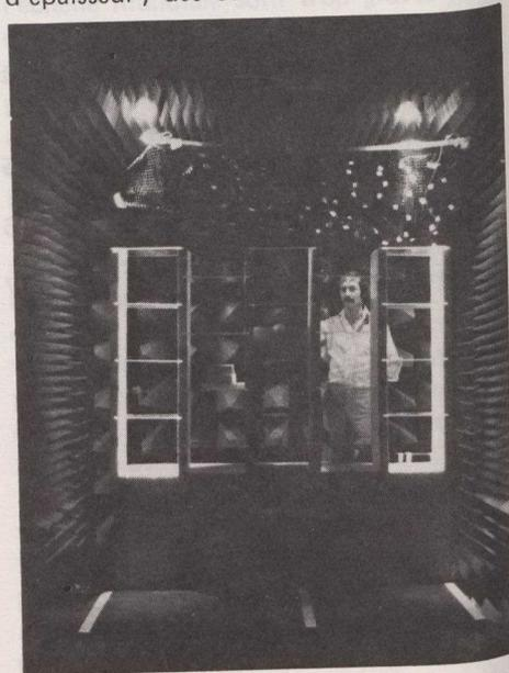
*Cette chambre, spécialement construite au CNRC d'Ottawa permet aux scientifiques de déterminer les niveaux d'exposition sans danger de tissus animaux au rayonnement micro-onde. Les constatations effectuées permettent d'établir des normes de sécurité réalistes pour des sources de rayonnement aussi communes que les émetteurs radio, les radars et les fours à micro-onde domestiques.*
