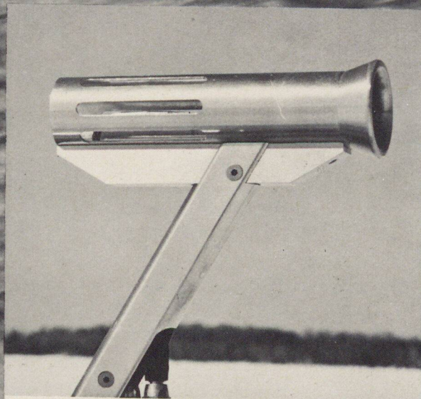
MHV Limited (Ottawa) "Spectra 2" air cushion vehicle after completion of speed trials. A fluidic sensor developed by the Low Speed Aerodynamics Section of NRC's National Aeronautical Establishment was mounted on top of the canopy to examine its use as a vehicle air speed indicator. ● L'aéroglesseur "Spectra 2", de la MHV Limited (Ottawa) après ses essais de vitesse sur base. Sur le haut de la verrière se trouve un capteur "fluidique" étudié par la Section de l'aérodynamique des basses vitesses, de l'Etablissement aéronautique national du CNRC. Ce capteur a été essayé comme indicateur de la vitesse du vent relatif, ou vitesse "aérodynamique".
