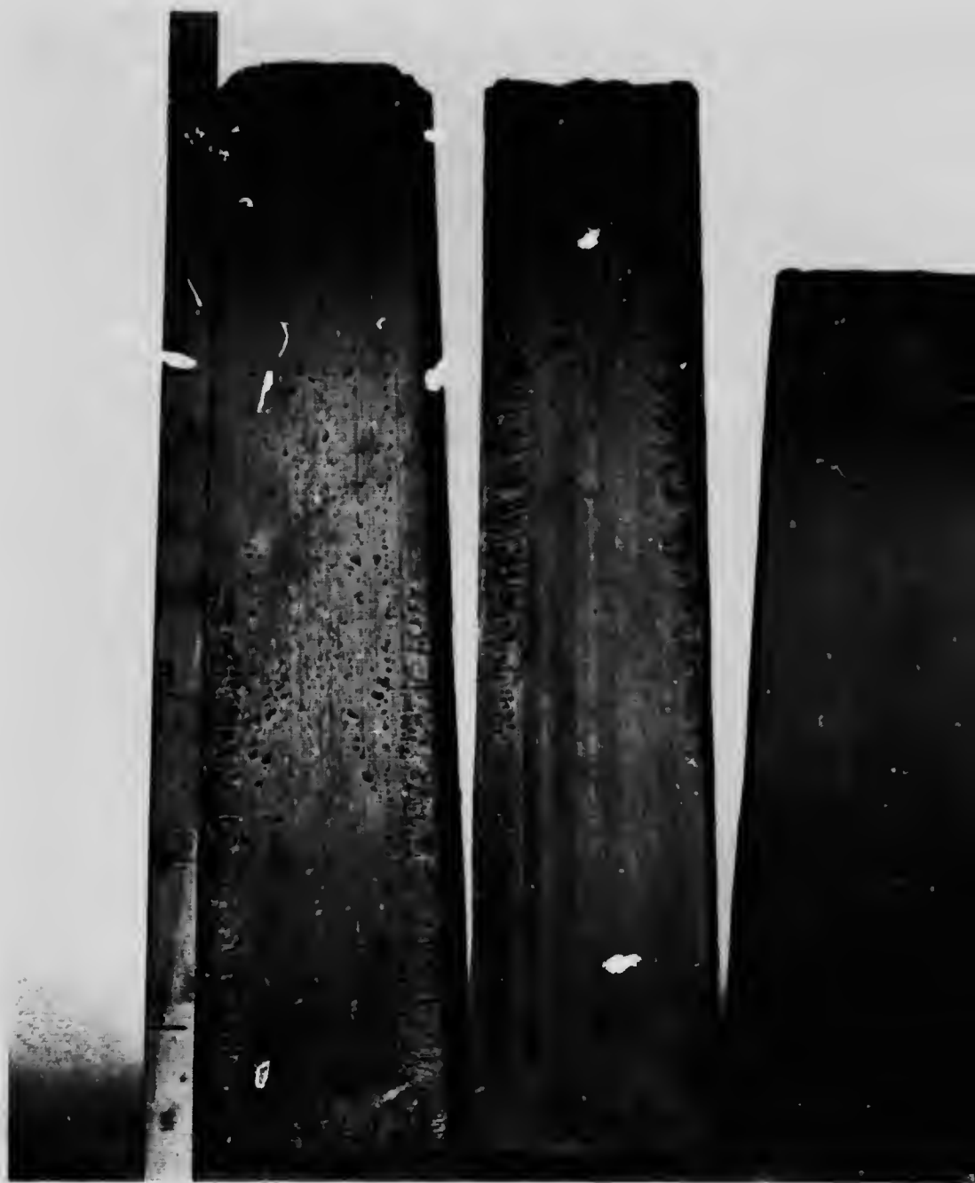
LINGOTS D'ACIER—No 3 COMPRIMÉ PAR LE PROCÉDÉ "HARMET."
