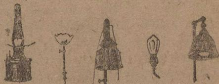
Lampe dite Rochester    Bec de gaz ordinaire    Manchon brûleur renversé    Ampoule électrique    Lampe Tunstall à réflecteur
