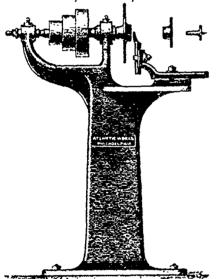
Fig. 4. SMALL FACE LATHE.
