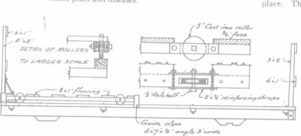
ELEVATION OF MAIN RACK AND SLIDING PLATFORM.
