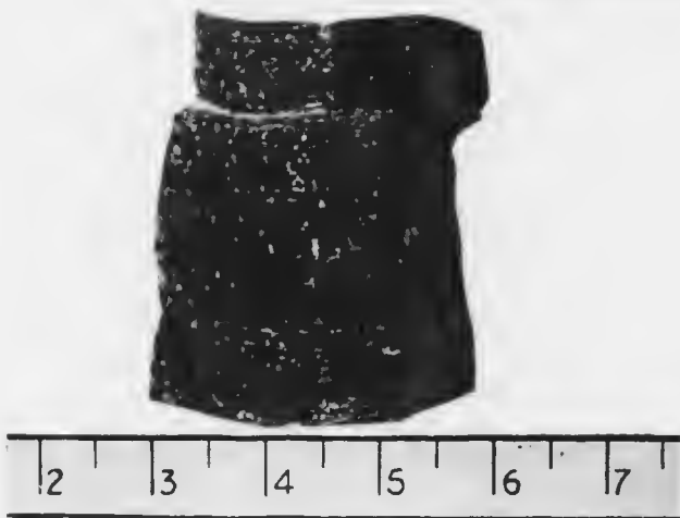
Cristal de phlogopite dont la portion supérieure a subi un mouvement de rotation de 20^{\circ} et cimentée dans sa position nouvelle par de la calcite, provenant de la mine Cantin, lot I, concession IV, Canton South Burgess, Ont.
