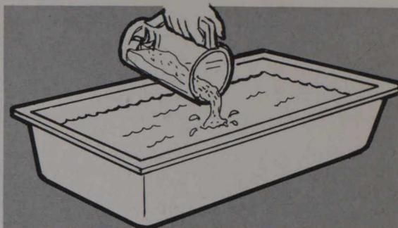
4) Cuando la pulpa esté licuada, se vierte en un recipiente lo suficientemente amplio para dejar entrar al bastidor en una posición horizontal. El recipiente deberá tener agua a una altura de 15 centímetros.
