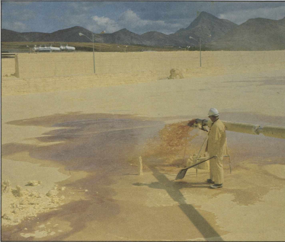
La récupération du soufre élémentaire des usines de traitement du gaz naturel, à des fins commerciales diverses, a permis de contrôler les émissions de SO 2 .
