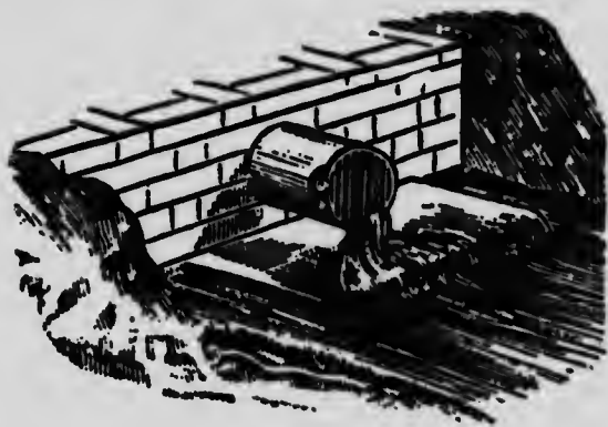
Fig. 19.—Décharge des drains avec grillage.
