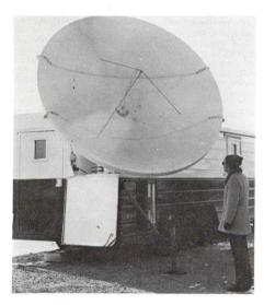
Esta estación terrestre de antena de unos 3 mts totalmente retráctil y generador propio, es lo bastante pequeña como para transportarla en un remolque.
