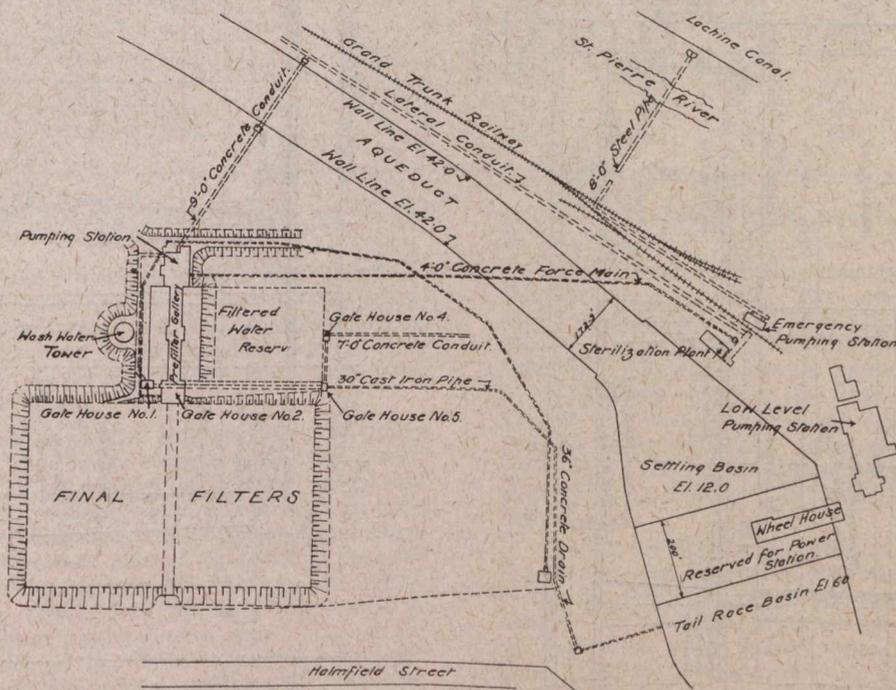
FIG. NO. 1—GENERAL PLAN OF FILTRATION WORKS
