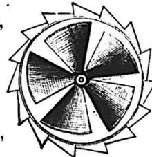
L'une des principales propriétés de ce ventilateur, c'est qu'il est mis en mouvement, non seulement par le moindre vent, mais aussi par la différence de température de l'intérieur et de l'extérieur de la bâtisse.
