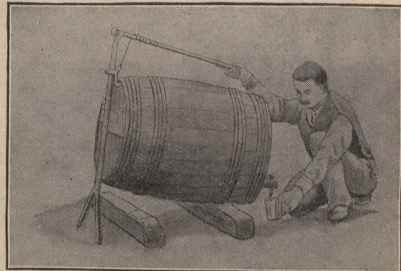
Appareil permettant de soulever les fûts en vidange et d'en soutirer le contenu sans aucun mélange avec la lie.
